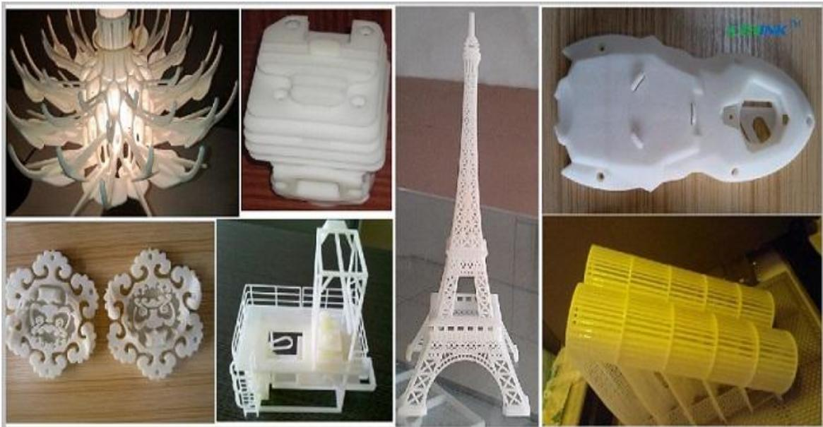
3D 打印技术出现在 20 世纪 90 年代中期，实际上是利用光固化和纸层叠等技术的最新快速成型装置。它与普通打印工作原理基本相同，打印机内装有液体或粉末等“打印材料”，与电脑连接后，通过电脑控制把“打印材料”一层层叠加起来，最终把计算机上的蓝图变成实物。这打印技术称为
